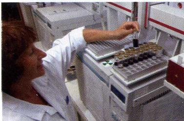
Quelques semaines avant les vendanges, peau et pépins sont analysés au laboratoire. Plusieurs manipulations (ci-dessus) permettent de mesurer le potentiel polyphénolique des grains qui influe sur la couleur et les arômes du vin.
