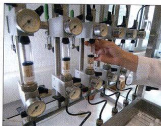
De la vérification de l'absence de trichloroanisol (à gauche) au test de pression (en haut), en passant par celui d'étanchéité (en bas), le laboratoire contrôle la qualité des bouchons.
